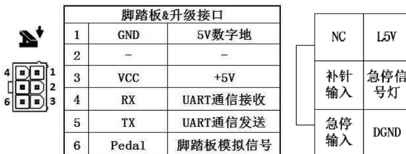
Рисунок 1-2-2. Соответствие разъемов блока управления
